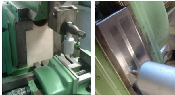
**IMAGEN 3: (a) Bruñidor en cepillo; (b) dos ensayos por probeta.**
