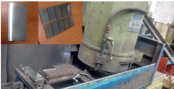
**IMAGEN 2: (a) Rectificado de probetas en la máquina VB100.**
