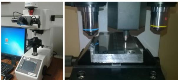
IMAGEN 4: (a) Micro-durómetro; (b) ensayo de dureza Vickers.
