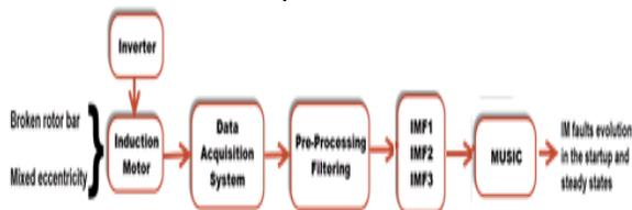
IMAGEN 3: Metodología propuesta para la detección de fallas para el motor de inducción en estado estable basado en la técnica de análisis espectral MUSIC
