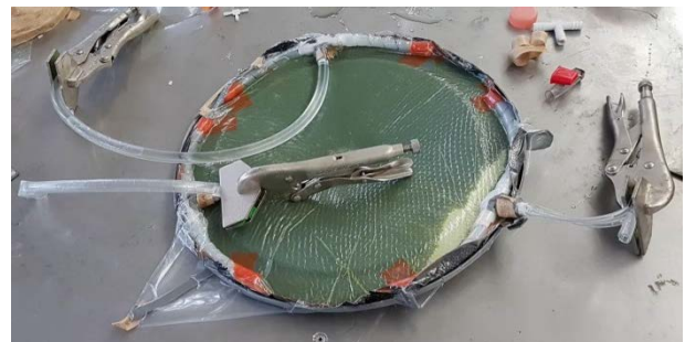
IMAGEN 9: Proceso de infusión de resina finalizado
