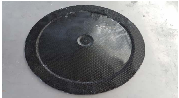
IMAGEN 13: Pieza final obtenida por el método VARTM
