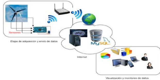
Imagen 4. Diseño de arquitectura para monitoreo de turbina eólica UG
