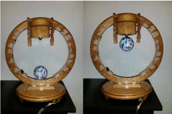
IMAGEN 1: Levitador magnético. En la imagen izquierda se muestra el levitador con la bobina des energizada y la imagen derecha la bobina energizada (lazo abierto).
