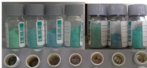
Figura 4. Mezclas de compuestos antes (parte superior) y después de ser sometidos a la calcinación (parte inferior) De derecha a izquierda: A a la G.
