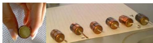
Fig 2. a) Llenado de las celdas de cobre con los diferentes compuestos. b) Celdas de cobre que contienen a los diversos compuestos
