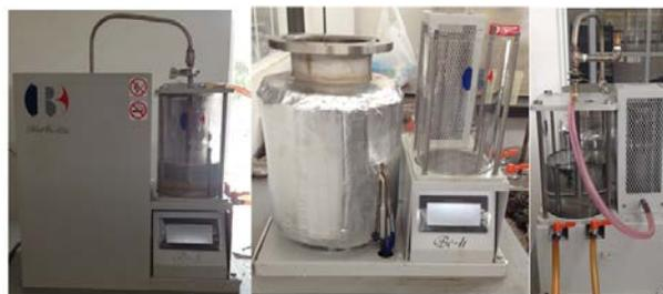
Figura 1.- Prototipo de pirolizador utilizado para la obtención de combustible a base de desechos plásticos de polipropileno.
