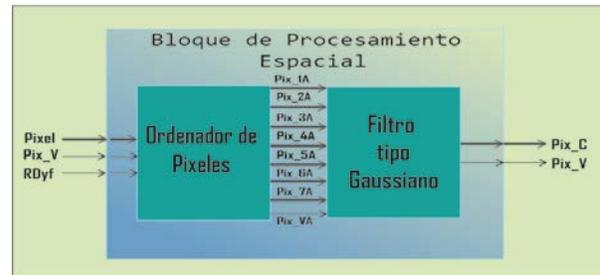
IMAGEN 3: Diagrama general del bloque de procesamiento espacial, con sus módulos y señales internas.
