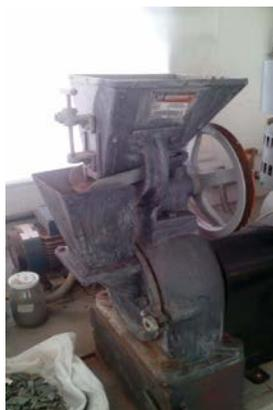
IMAGEN 1: Molino de martillos, instrumento de desintegraciones mecánicas; laboratorio de ingeniería química, DCNE de la Universidad de Guanajuato.
