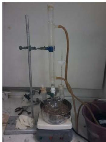
IMAGEN 2: Sistema para llevar a cabo la lixiviación en un matraz de 3 bocas de 500 mL, a temperatura con baño maría y a reflujo con agua de enfriamiento
