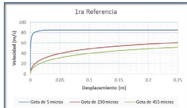
IMAGEN 3: Perfiles de velocidad de las gotas dentro de la cámara de mezclado para la 1er referencia en el cálculo del coeficiente de arrastre.
