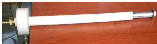
FIGURA2: Prototipo del tubo Vortex
