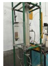
Imagen 5. Columna de fluidización del Laboratorio de Silicio del Depto. De Ingeniería Química, DCNE, UG.
