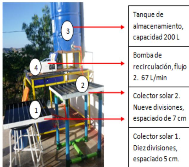
Figura 1: Sistema de remoción, colocado en serie (dos colectores, un tanque de almacenamiento y una bomba de recirculación)
